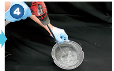
ダマがなくなるまでミキサーを用いてよく混ぜます。(2~3分位)
