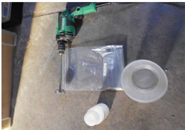
1 混錬容器、ミキサー（少量ならへらでも可） バインダーと防錆パウダー（重量比で2：8）
